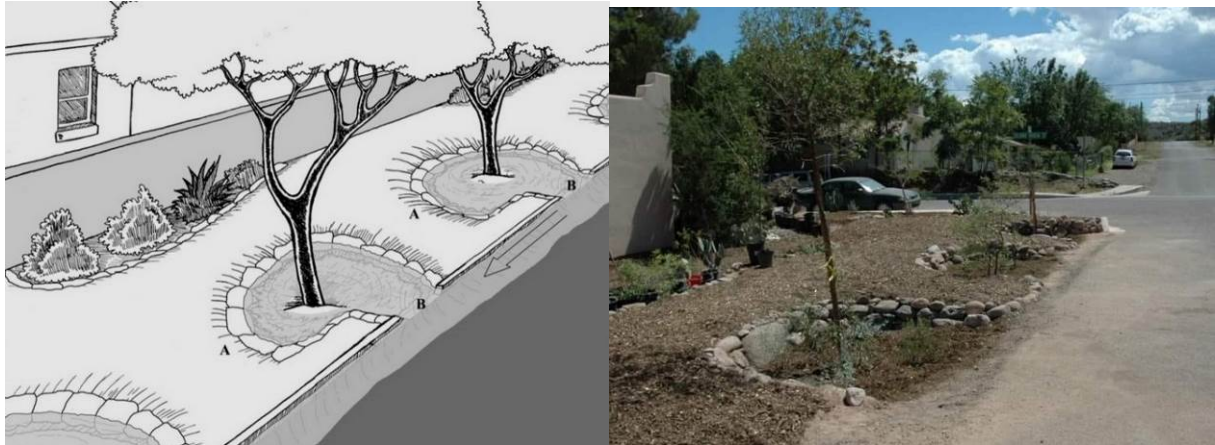
Példa a közút menti, egyszerűen megvalósítható szikkasztók/esőkertek alkalmazására (forrás https://harvestingrainwater.com )
