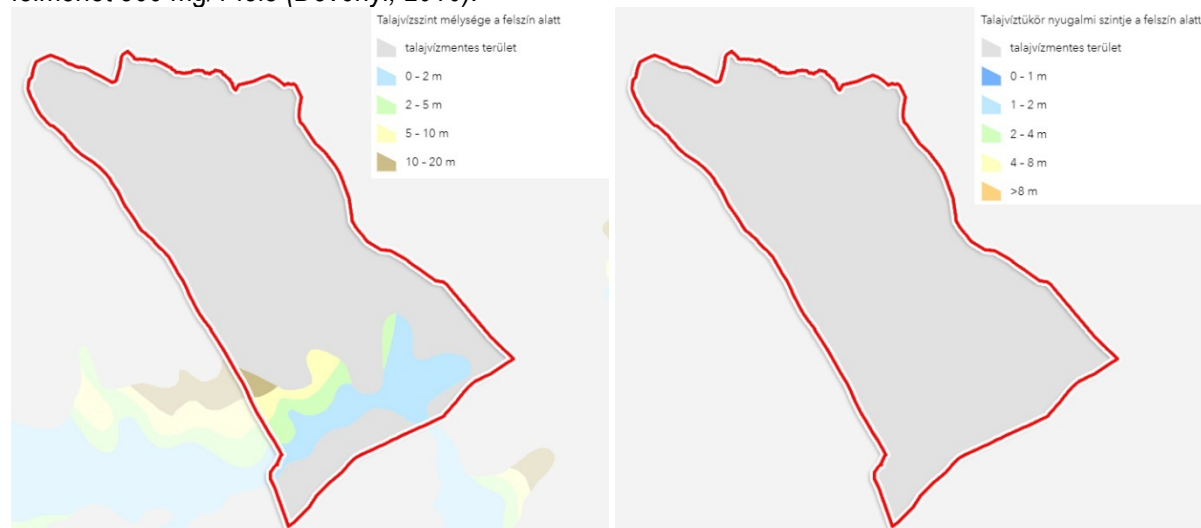
Talajvízszint mélysége a felszín alatt (balra) és a talajvíztükör nyugalmi szintje a felszín alatt (jobbra) (forrás: Magyar Bányászati és Földtani Szolgálat)
